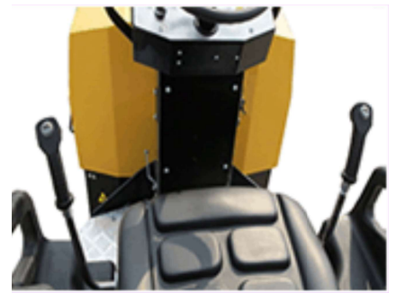
Alavanca de controle dupla, com controle de segurança da aceleração.
